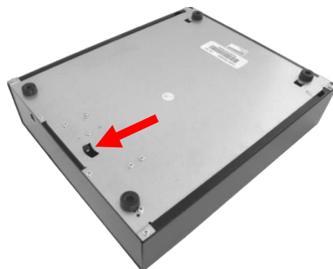
Vo dne zásuvky je v zadnej časti umiestnený kolík pre núdzové otvorenie (funguje iba v režime el. otváranie)
